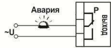
Подключение аварийной сигнализации
